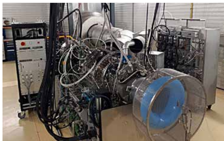
Figure 4 : Avec son banc BEARCAT fortement instrumenté, Safran Tech est en mesure d'étudier finement l'impact de différents carburants substitutifs sur le comportement d'un moteur réel (© Safran).
