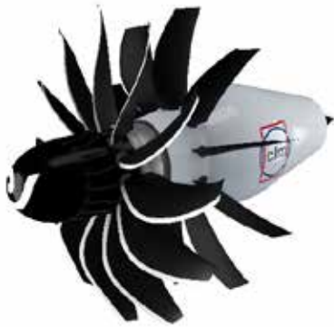
CFM RISE – Open Fan, moteur à architecture non carénée (Crédit : CFM International).
