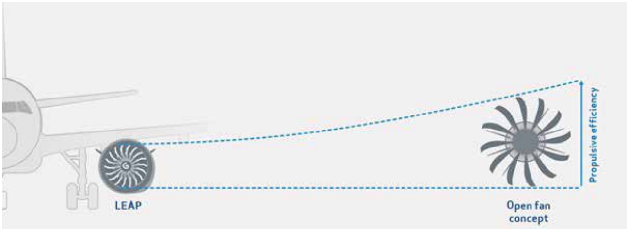
Comparaison entre le concept CFM RISE – Open Fan et le moteur LEAP actuel (Crédit : CFM International).
