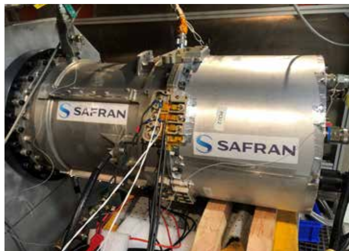
Figure 8 : Exemple de tests de décharges partielles sur une machine 500 kW réalisés chez Safran (© Safran).
