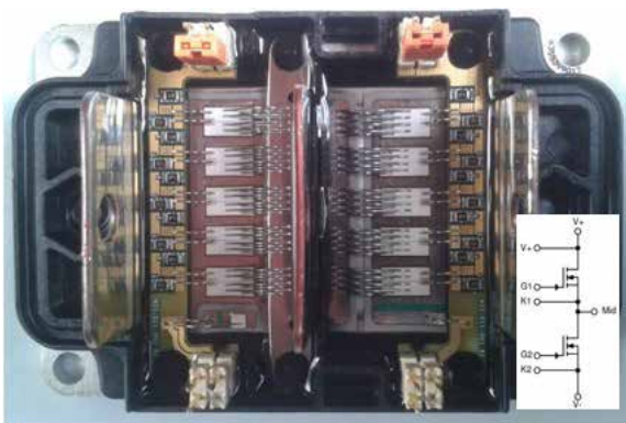
Figures 14 et 15 : Vue interne d'un module de puissance 1,2 kV SiC MOSFET et phase 18 kW d'un onduleur SiC multiniveau entrelacé couplé (© Safran).
