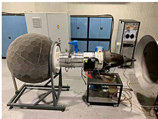
Figure 6 : Avec son programme MATCH, Safran a élaboré et validé expérimentalement les principes d'hybridation électrique d'un turbofan à double corps et double flux (© Safran).
