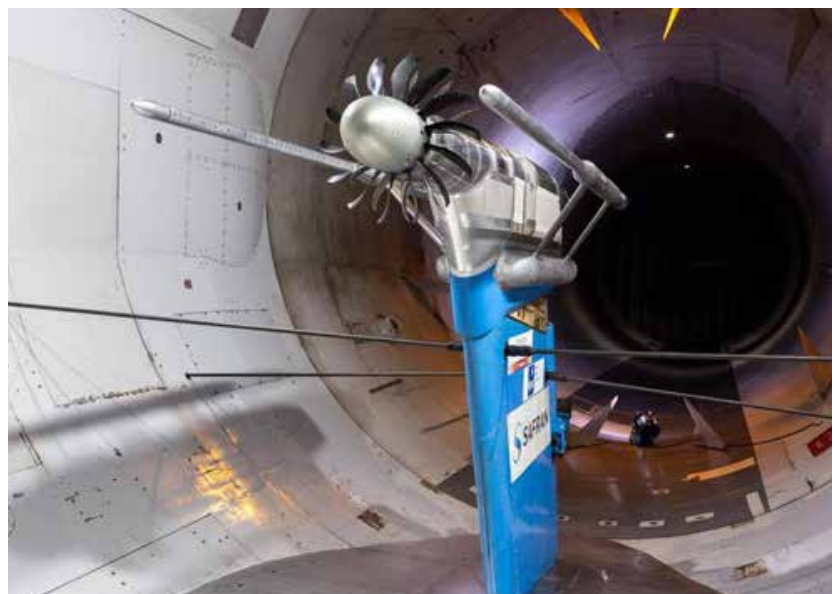
EcoENGINE (démonstrateur 1/5 e de l'Open Fan RISE) dans la soufflerie S1MA de l'ONERA à Modane.
