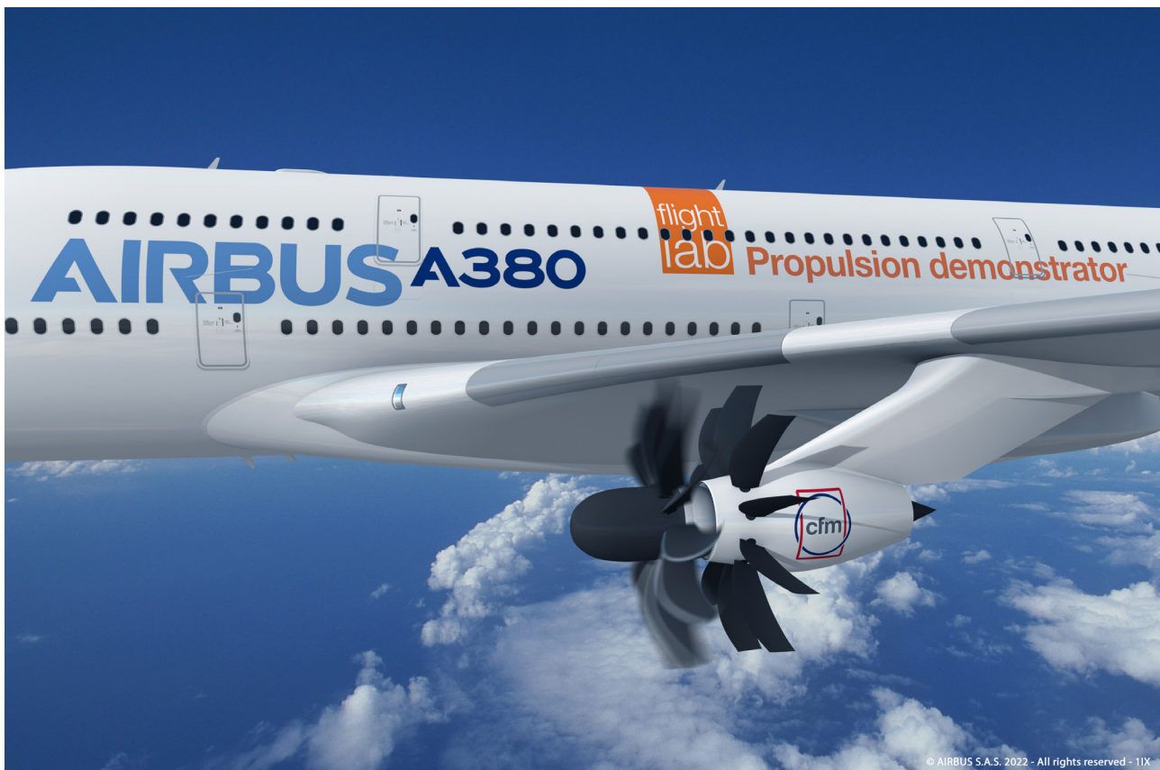
A380 Démonstrateur CFM Open Fan (© Airbus 2022).
