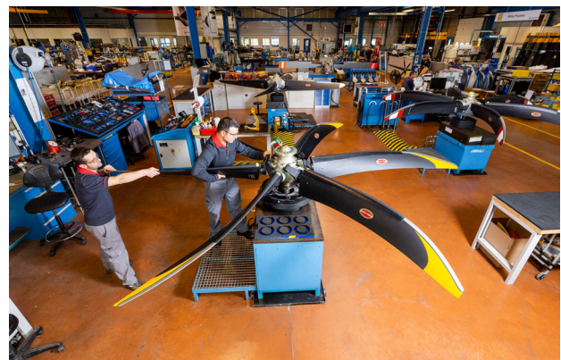
Hélice ATR à l'assemblage (© Collins Aerospace).
