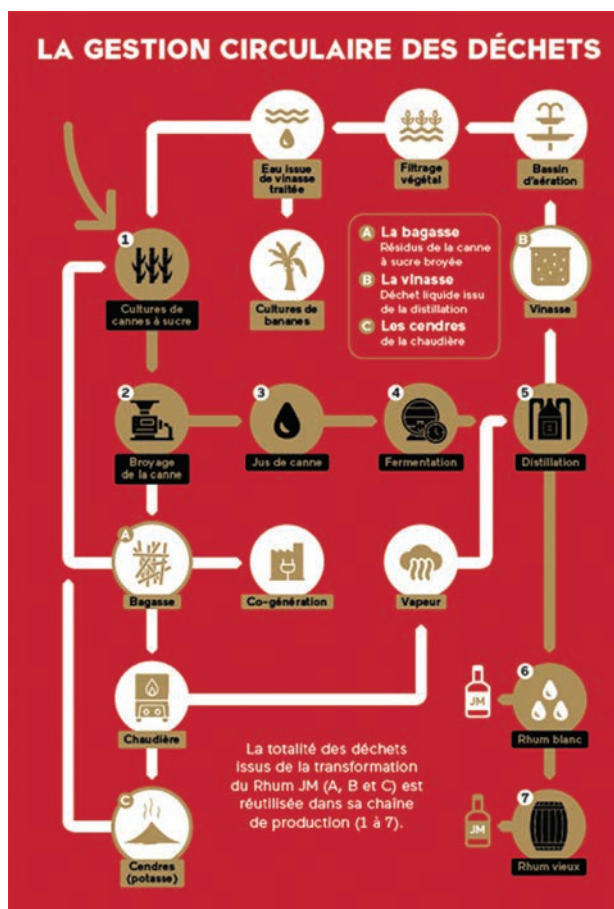
Figure 9 : Schéma de la gestion circulaire des déchets par la Distillerie de Fonds-Préville.
