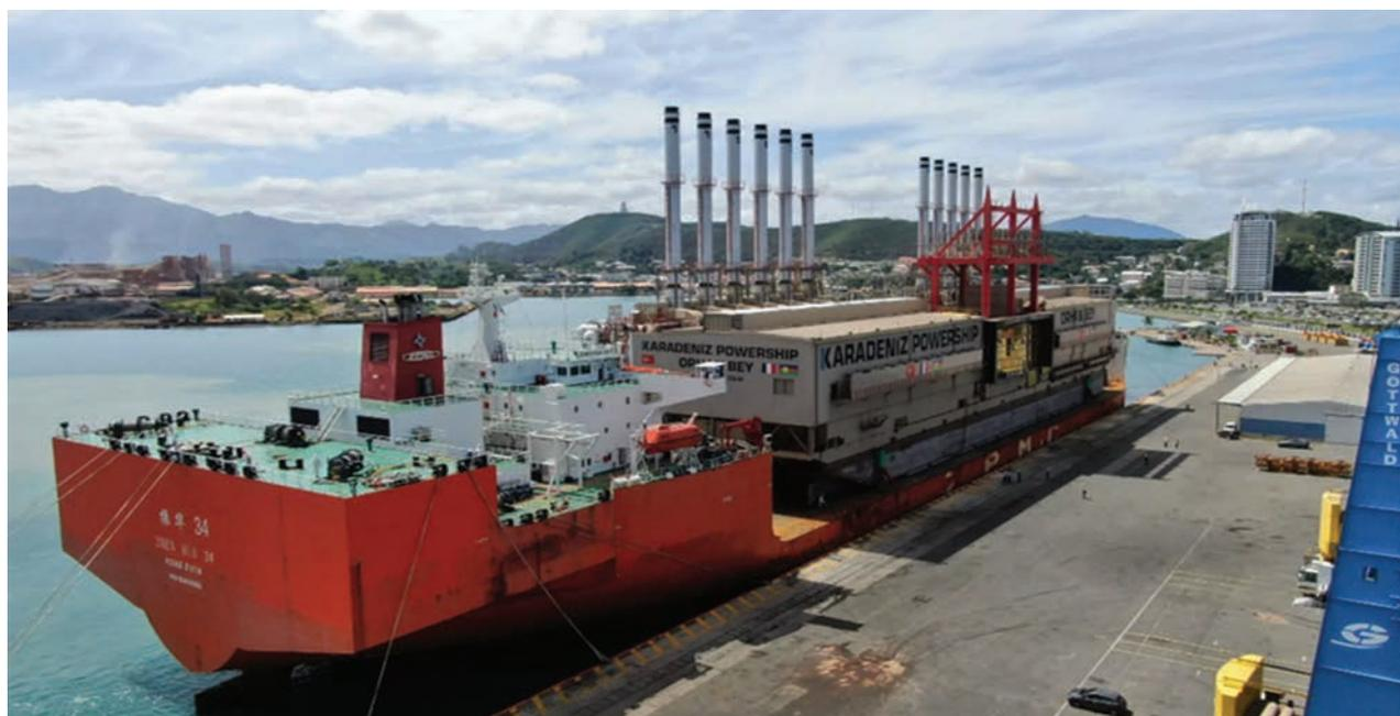
Figure 10 : Centrale accostée temporaire (CAT) au fioul de la SLN pour l'alimentation électrique de Doniambo (Crédit photo : Outremers 360°, nov. 2022).
