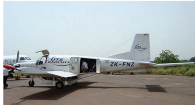
Figure 2 : Appareil utilisé pour opérer les levées aéroportées – Source : Photos Hydroma.
