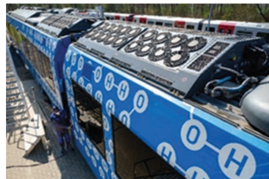
Équipements installés en toiture (réservoirs et piles H 2 ).
