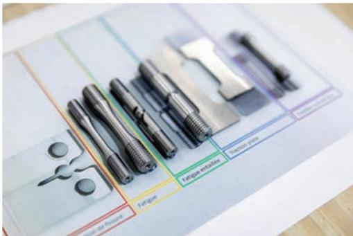
Figure 2 : Échantillons d'acier issus de canalisations en exploitation – Photo©GRTgaz.
