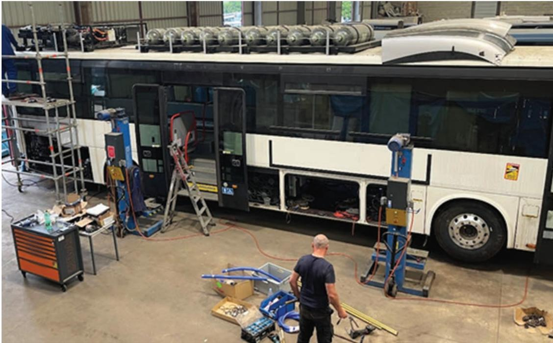
Figure 6 : Installation en toiture des bonbonnes d'hydrogène et de la pile à combustible (photo©Transdev Normandie).
