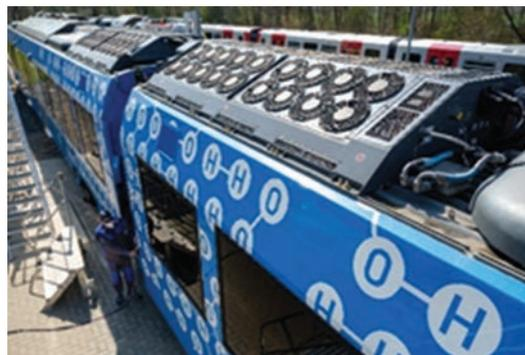
Équipements installés en toiture (réservoirs et piles H<sub>2</sub>).
