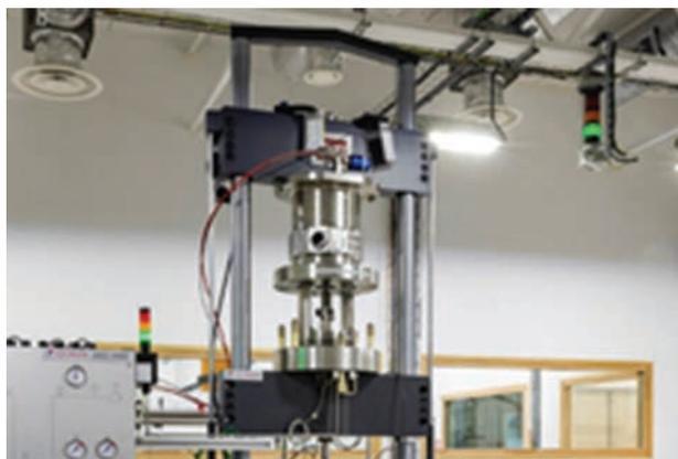
Figure 3 : Machine servant à des essais de traction sous atmosphère hydrogène – Photo©GRTgaz.
