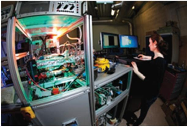
Figure 7 : Banc d'essai de piles à combustible de type PEMFC (puissance 1 kW) – Photo@uFC.
