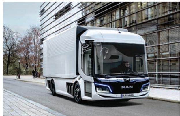
Figure 1 : Camion électrique e-TGM de 26 t de PTAC – Source : MAN (Group Volkswagen).
