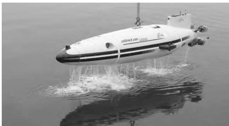
Photo 4 : l'Alistar-3000, AUV d'inspection (utilisable jusqu'à 3 000 m de fond) (Source : ECA).
