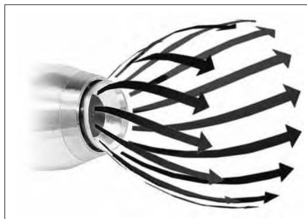
Figure 3 : Coupelle et jupe d'air vortex.
