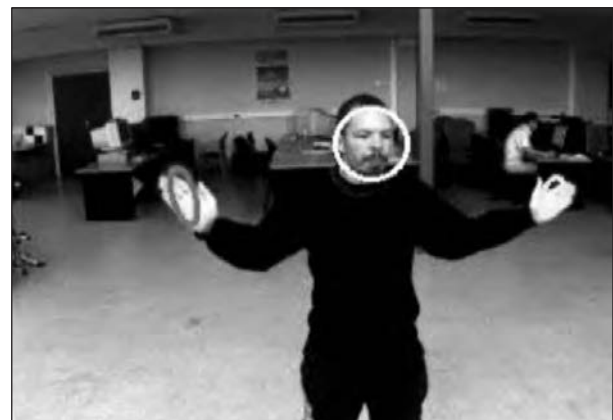
Figure 10 : Exemple de suivi visage-mains, entrée d'une fonction de détection de gestes (© CNRS)
