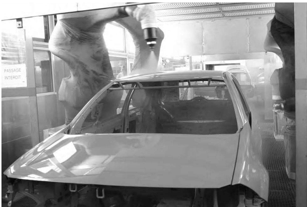
Figure 5B : Application robotisée sur les intérieurs des véhicules produits sur le site de Renault-Douai.
