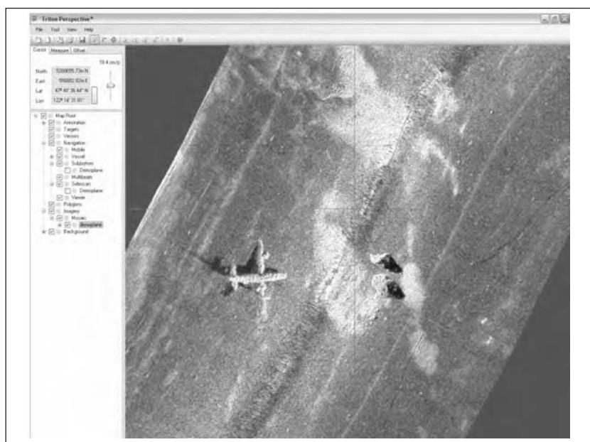
Photo 5 : Image d'une épave d'avion obtenue par post-traitement de signaux sonar (Source : ECA/ Triton Imaging Inc.).
