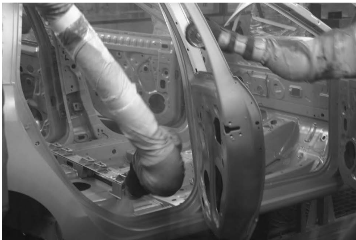
Figure 5A : Application robotisée sur les intérieurs des véhicules produits sur le site de Renault-Douai.
