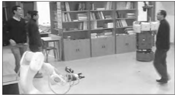
Figure 7 : Détection de l'homme à partir d'informations multimodales : badge RFID et vision (© CNRS)
