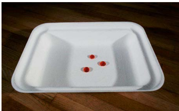
Photo 1 : Barquette alimentaire hydrophobe contenant des microfibrilles de cellulose (MFC) (Crédits photos : CTP).
