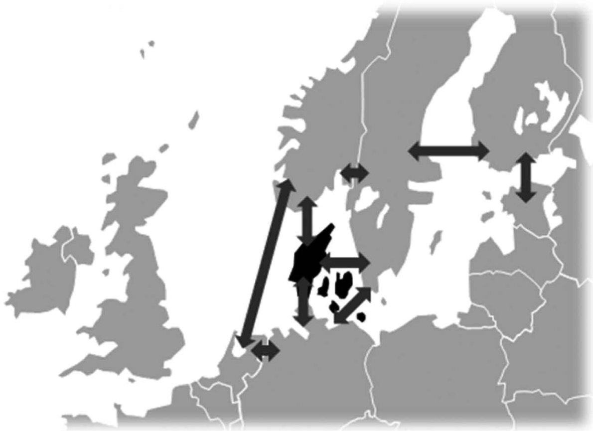
Figure 2 : Les interconnexions composant le réseau électrique nordique.
