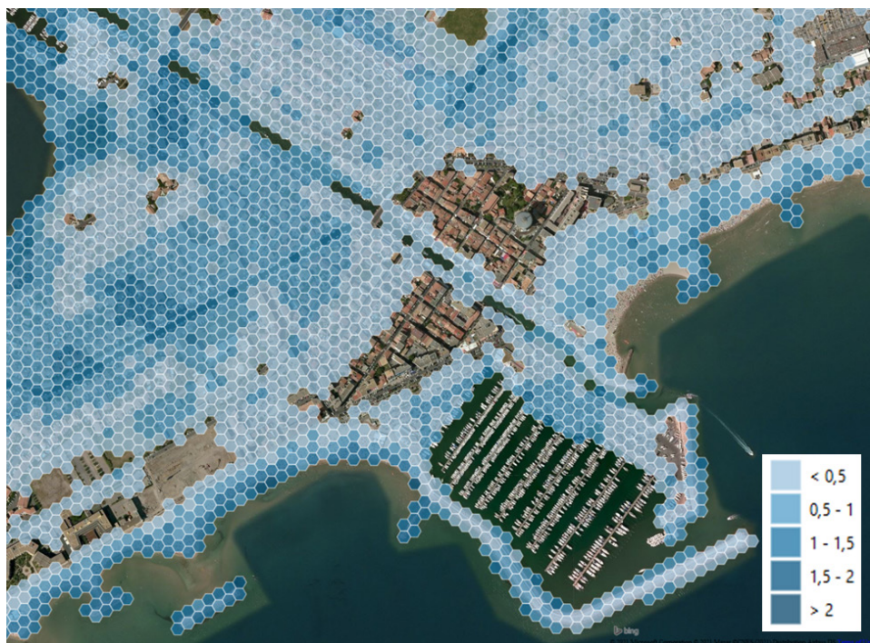
Figure 4 : Estimation d'une submersion côtière en 2100 en prenant en compte les tendances régionales liées à l'élévation du niveau de la mer observée par altimétrie depuis 1993 et des effets d'une onde de tempête décennale (hauteur d'eau au-dessus des terres en mètres) (Crédits : CLS et Cnes).
