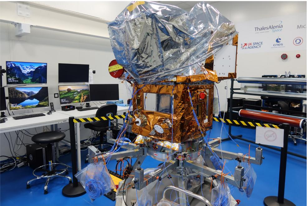
Figure 9 : Le microsatellite MicroCarb en intégration (© Cnes).
