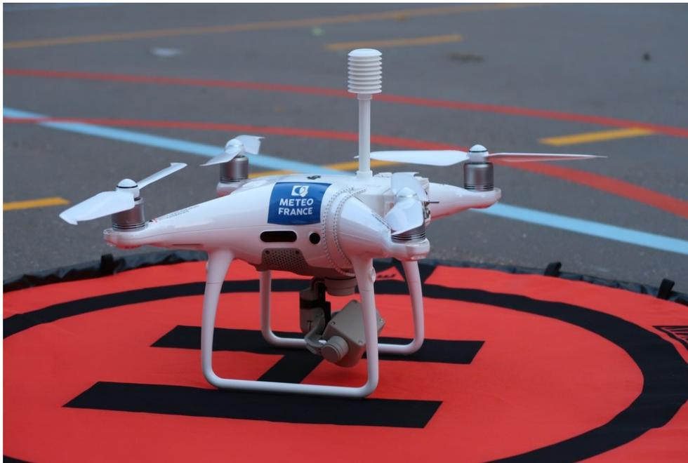
Figure 6 : Drone permettant de caractériser l'effet rafraîchissant des parcs végétalisés en conditions de canicule (Source : Météo-France).
