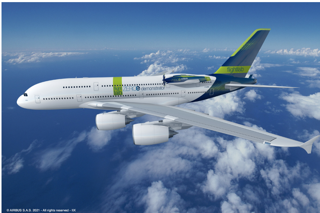
Démonstrateur en vol A380 de moteur à pile à combustible hydrogène (© Airbus 2022)
