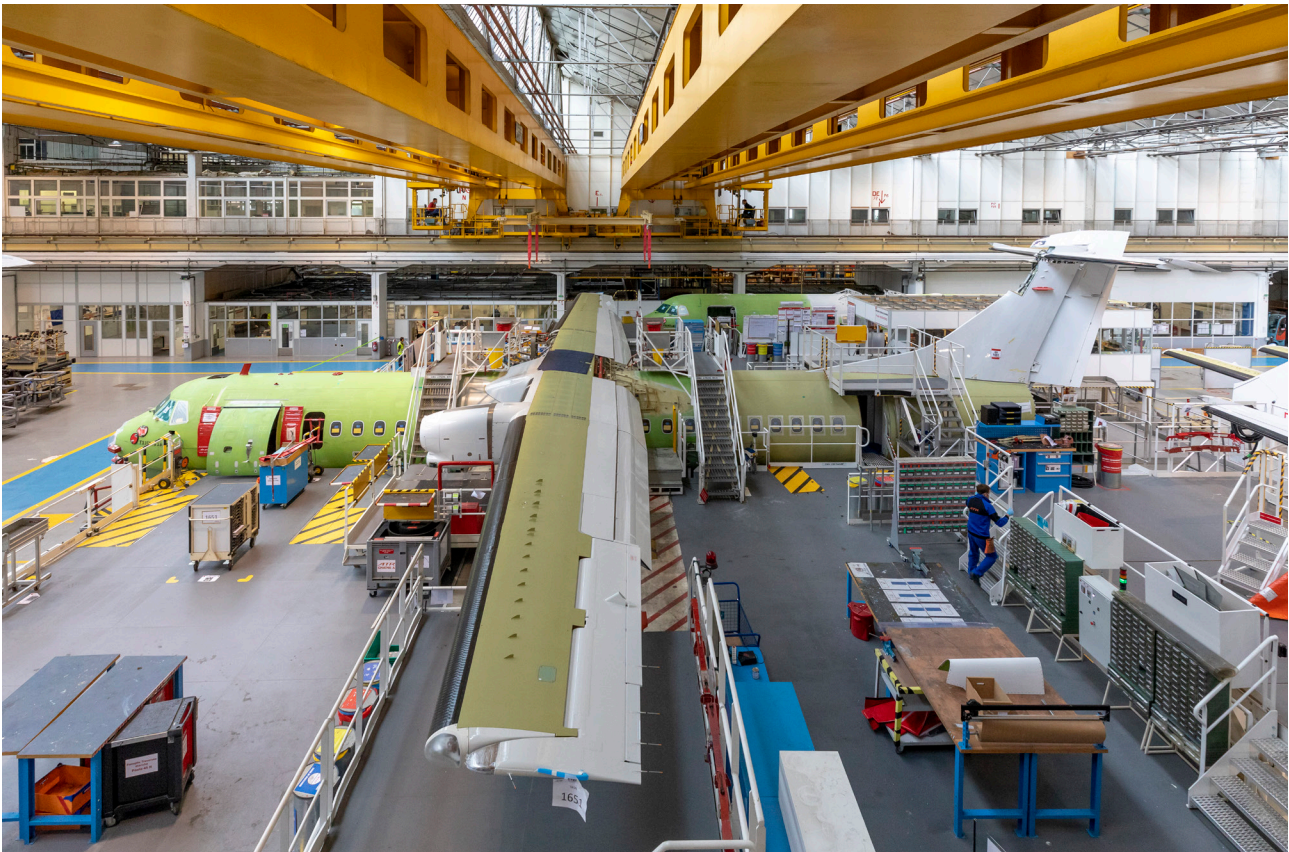
Figure 7 : un ATR en cours d'assemblage sur le site du constructeur, à Toulouse (© ATR).
