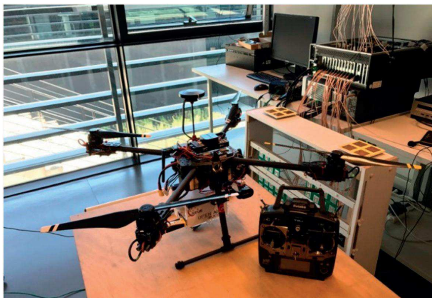
Figure 1 : Station de base cellulaire volante. Le prototype, développé en France par Eurecom, peut assurer une extension de connectivité. Il peut aussi servir de capteur autonome pour la localisation des nœuds terrestres.
