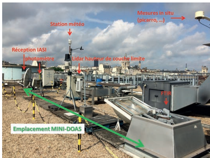
Figure 4 : Emplacement du mini-DOAS au sein de la plateforme QUALAIR.
