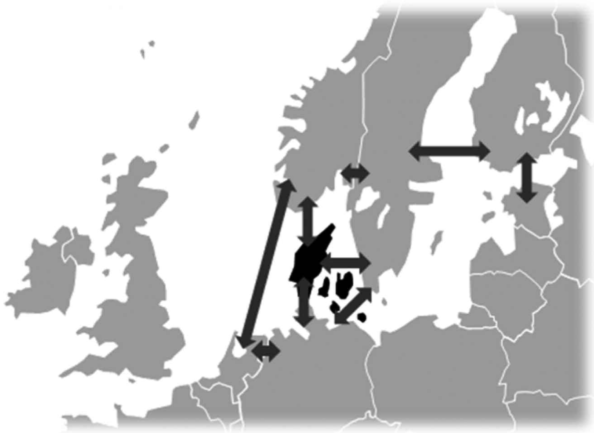
Figure 2 : Les interconnexions composant le réseau électrique nordique.
