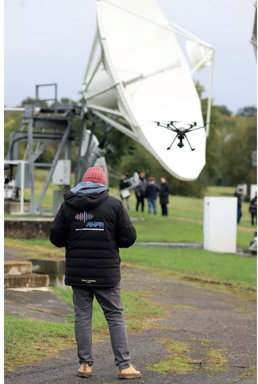
Utilisation d'un drone à des fins de vérification de la conformité d'un site radioélectrique : le site d'Aussaguel de télécommunications par satellite. © ANFR
