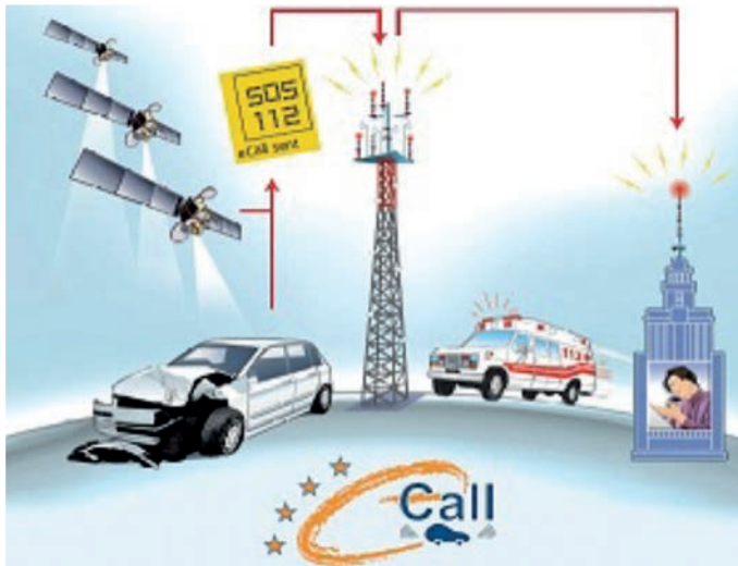
Figure 3 : Le système eCall, d'après (CE-eCall, 2018).
