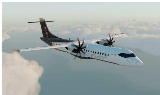
Figure 6 : ATR a lancé une étude de pré-faisabilité pour le développement d'un concept d'avion hybride baptisée ATR EVO (© ATR).
