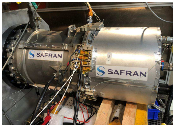
Figure 8 : Exemple de tests de décharges partielles sur une machine 500 kW réalisés chez Safran (© Safran).
