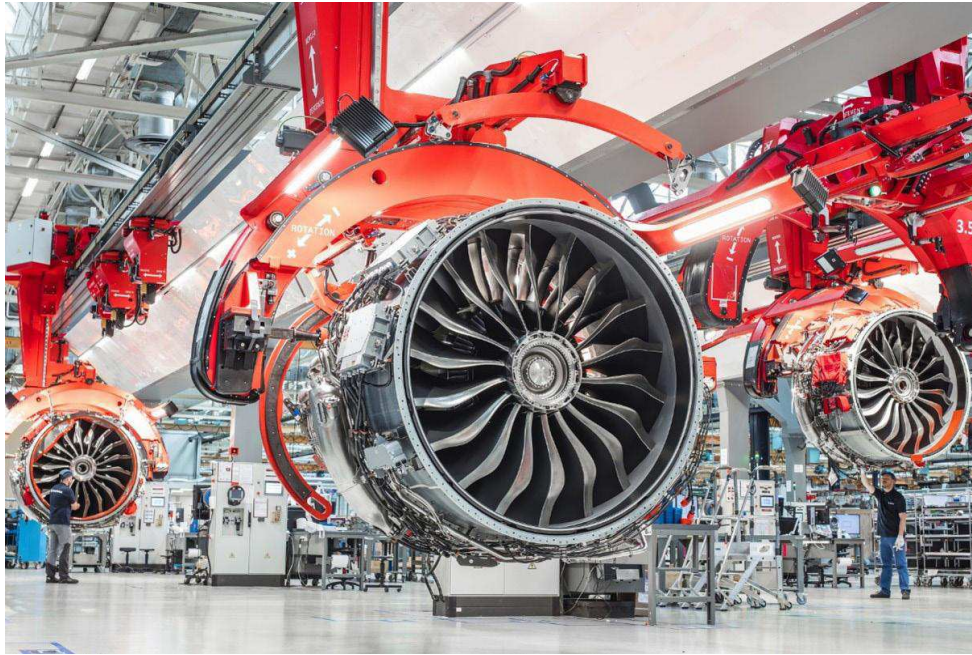
Ligne de montage du moteur LEAP (crédit : Adrien Daste / Safran).
