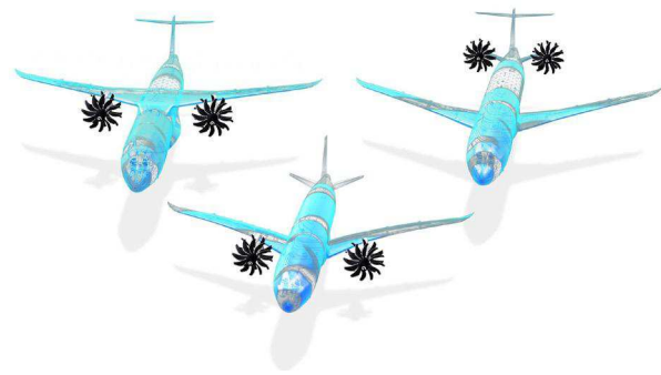
Figure 4 : Étude d'installation du moteur Open Fan (Source : CFM International).
