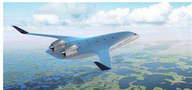
Figure 1 : Vue d'artiste de la configuration BWB de JetZero (Source : US Air Force).
