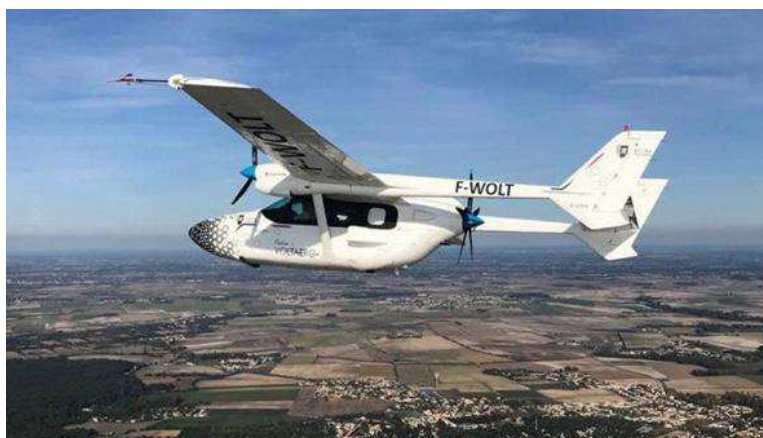
Figure 4 : L'avion de démonstration Cassio de VoltAero valide la configuration du groupe motopropulseur de Cassio (motorisation hybride thermique-électrique), et dé-risque sa viabilité en vue d'obtenir la certification de navigabilité. Il a déjà parcouru 10 000 km (© VoltAero).
