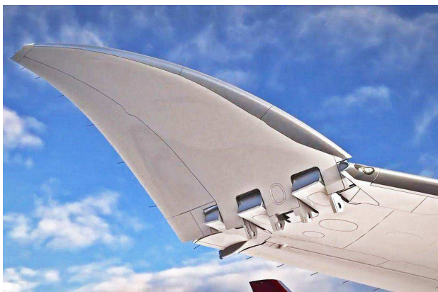
Figure 2 : Extrémité d'aile repliable B777X (Source : Boeing).
