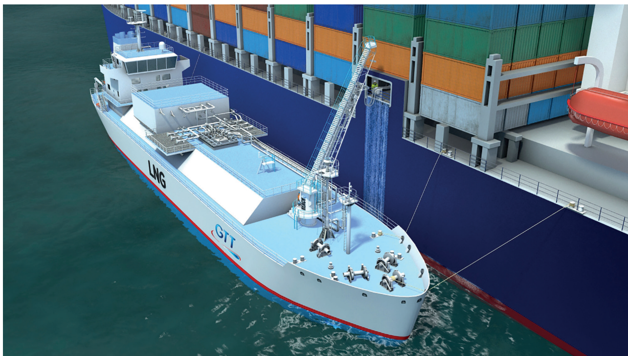
Barge équipée du système de mât de soutage innovant appelé REACH4.
